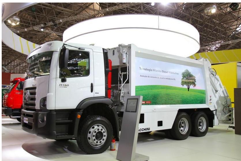
**Figura 31: Caminhão MAN 24.280 com sistema de propulsão híbrido diesel hidráulico HRB**
