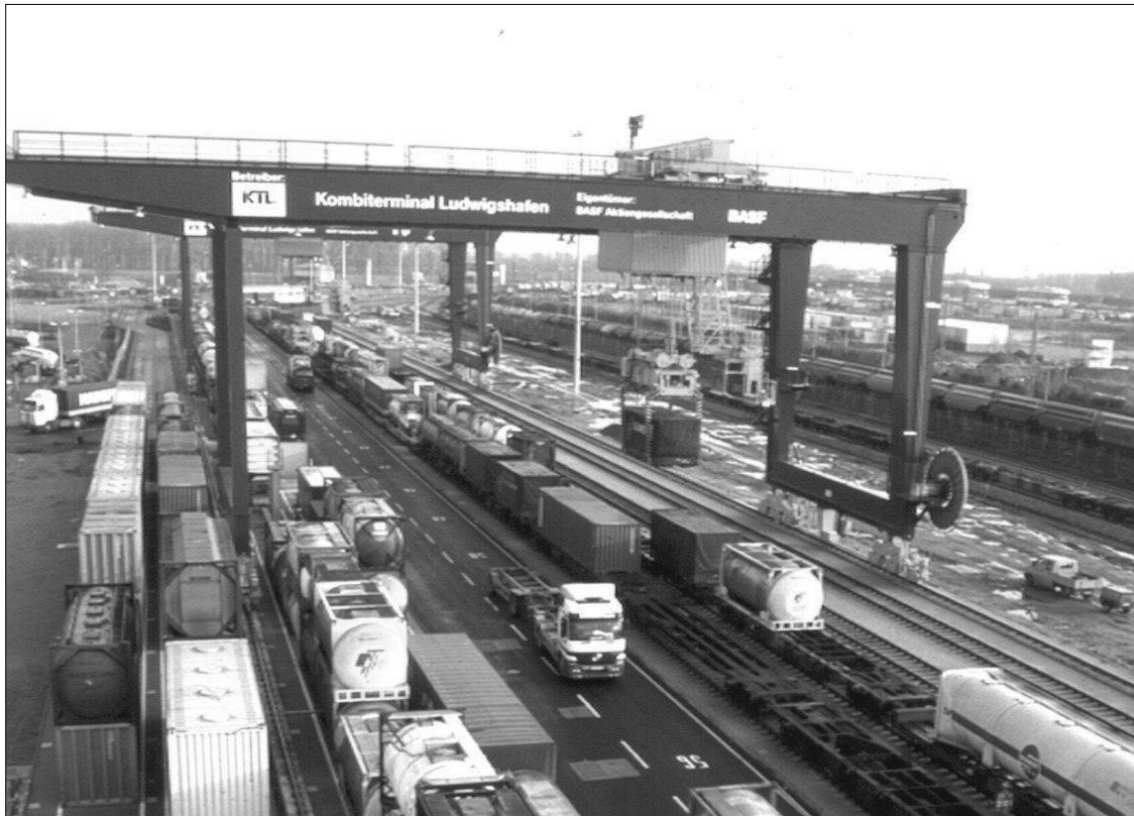
FIG. 2.7 – Transferências de cargas em um IIC ( Intermodal Interface Center )
