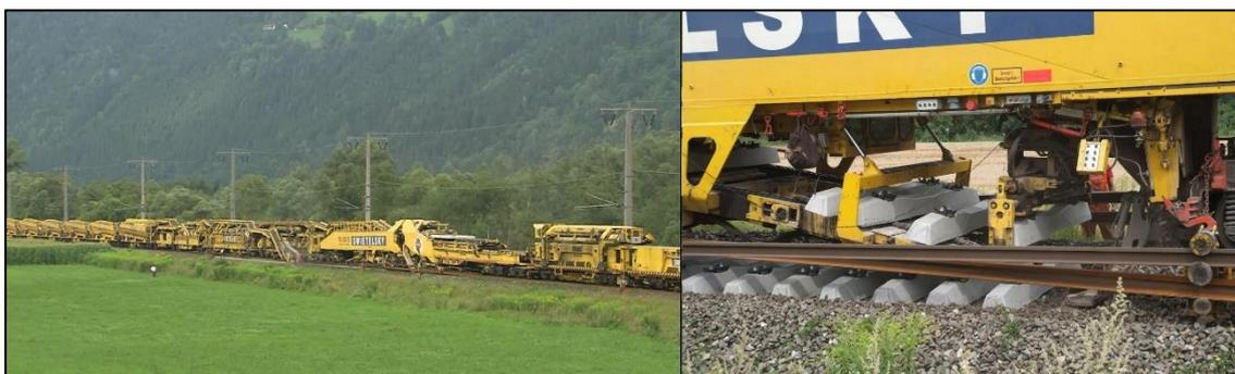
Figura 2.22: Renovadora automática de via. À esquerda – imagem que demonstra as dimensões do equipamento. À direita – ponto de renovação onde é visto o assentamento de novos dormentes e as barras de trilho nova e velha emparelhadas.
