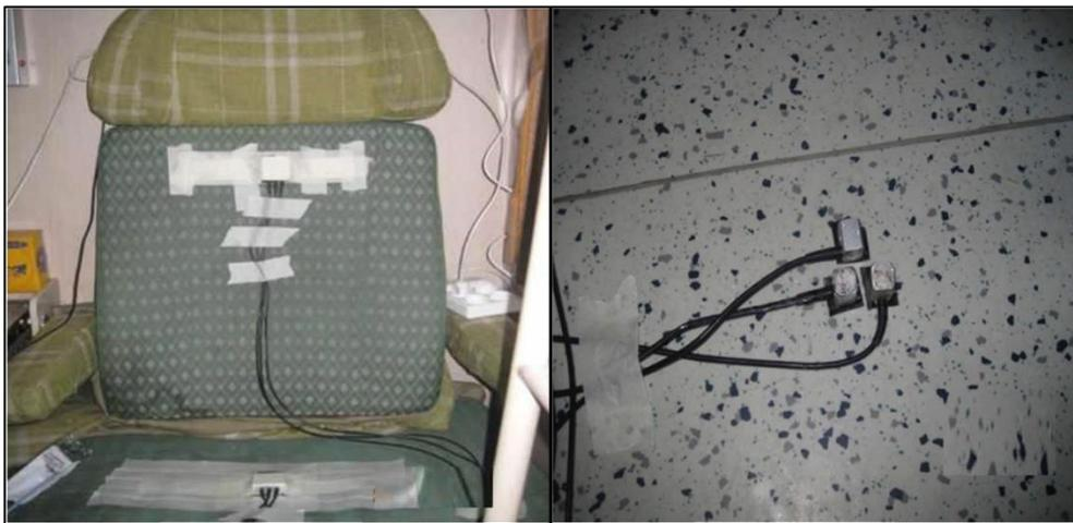
Figura 2.12: Acelerômetros instalados no interior do veículo. À esquerda, sensores posicionados no assento dos passageiros; à direita, acelerômetros no piso do veículo.
