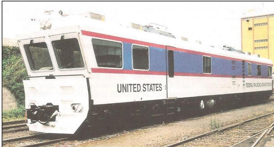
Figura 2.9: Carro controle utilizado pela FRA.
