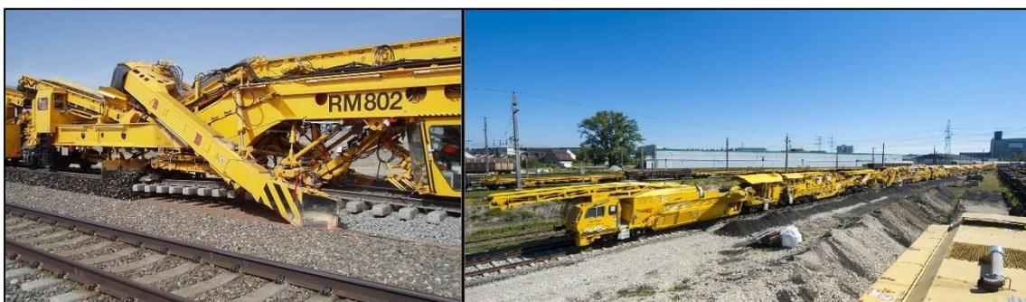
Figura 2.19: Desguarnecedora automática de via. À esquerda é apresentado o ponto de retirada do lastro e descarga da brita peneirada, destacando-se a grade suspensa no meio deste processo. À direita destaca-se a dimensão do equipamento.
