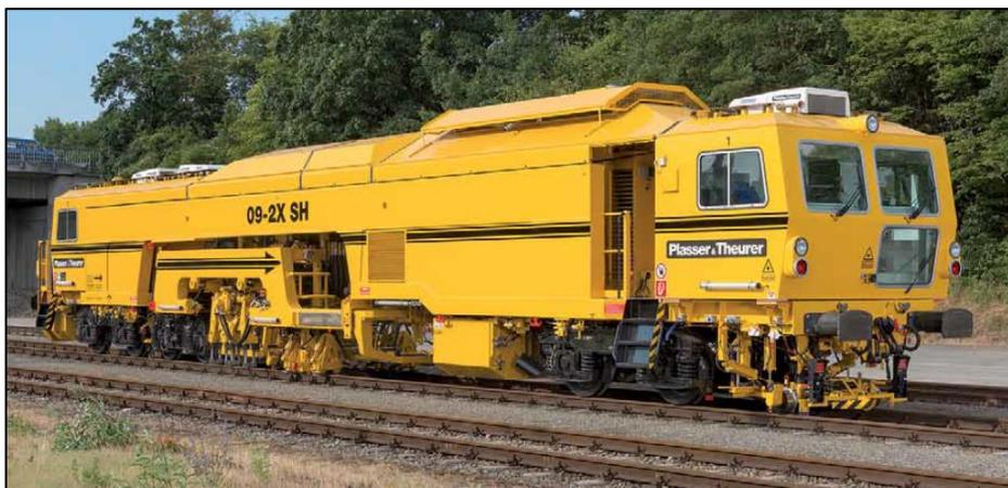
Figura 2.16: Socadora de via modelo 09-2X SH fabricada pela austríaca Plasser&Theurer.
