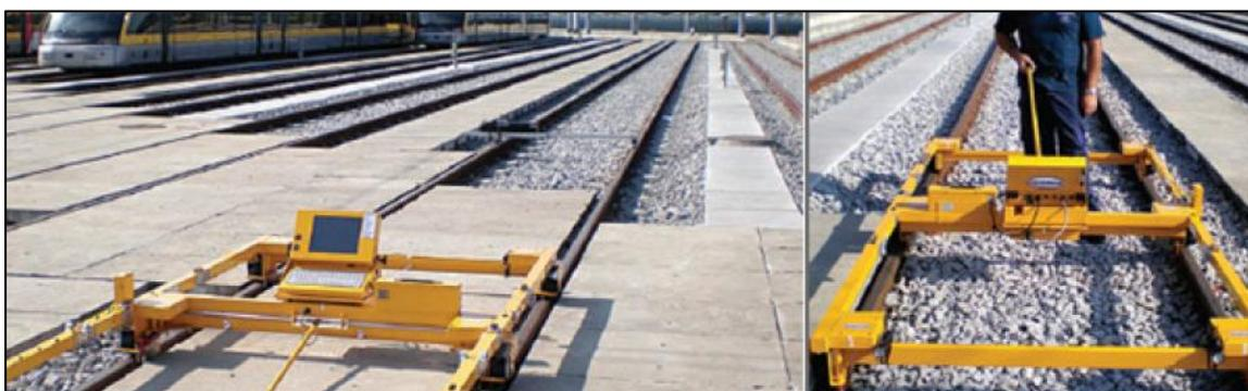
Figura 2.8: *Trolley* de inspeção.
