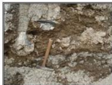
Foto 2. Corte de suelo excavado en el estribo derecho.
