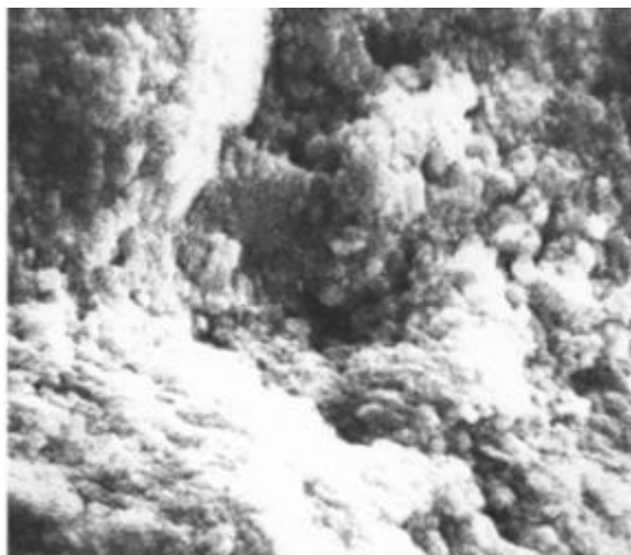
Figura 2.4 – Fotografia de microscopia eletrônica de um solo laterítico (NOGAMI e VILLIBOR, (1995).
