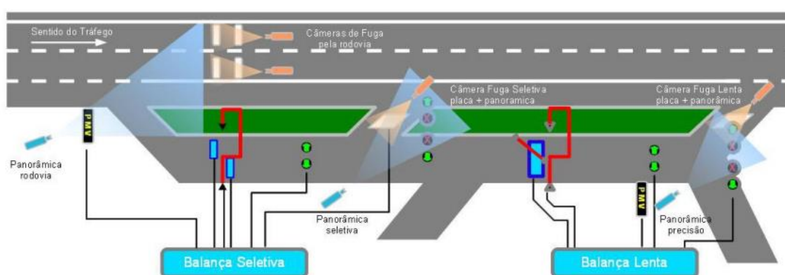
Figura 1.2: Sistema de detecção automática de fugas. Fonte: Adaptado pelo autor (2023)
