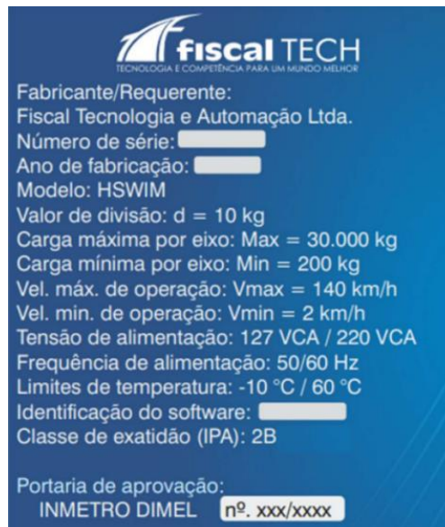
Figura 2.3: Placa de identificação com características metrológicas. Fonte: INMETRO (2022)
