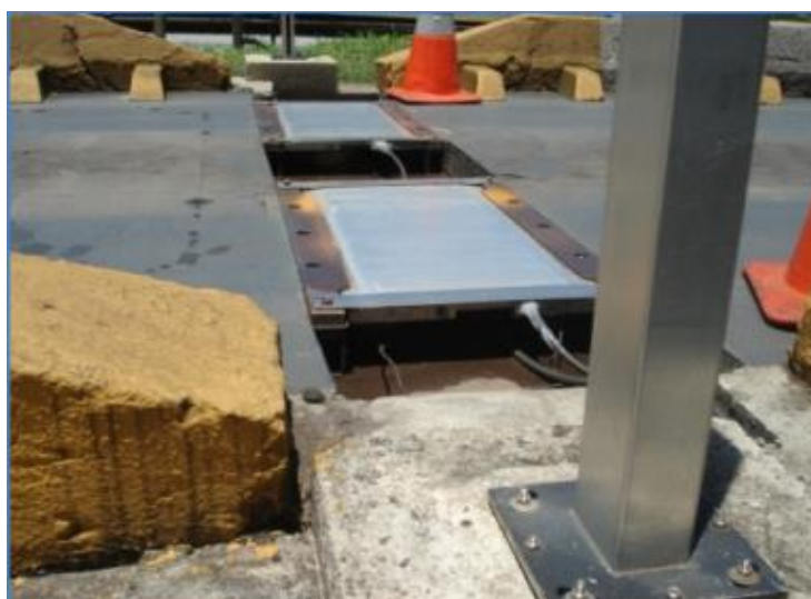
Figura 2.14: Sistema de pesagem por célula de carga Fonte: Faroulo (2015)
